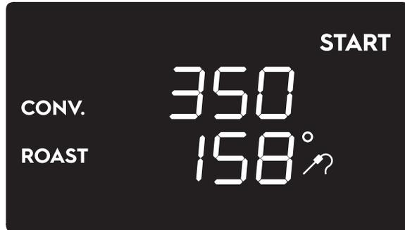
3. Appuyez sur le bouton de température du four pour changer la température de l'intérieur du four. L'afficheur montrera la température par défaut à l'intérieur du fond du four avec le symbole de degré clignotant. Le mot « **START** » disparaît.
