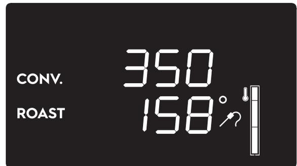
1. Appuyez sur le bouton de température du four pour changer la température cible de la sonde à viande et de l'intérieur du four comme cela a été fait lors du réglage du cycle de cuisson.
