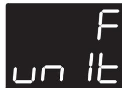
En tournant le bouton de température vers la droite, l'afficheur bascule entre °C et °F.
