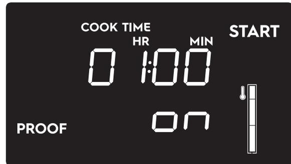
3. En appuyant sur le bouton de température du four vous pouvez régler une minuterie de rappel ou changer la durée par défaut de la fonction (voir « Minuterie de cuisson » et « Cuisson minutée »).
