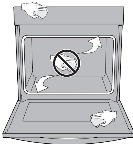
Figure 10: Ne nettoyez pas le joint de la porte du four
