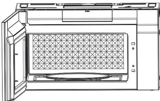
4. Retire el filtro de carbón vegetal empujando la parte superior del filtro hacia dentro y, a continuación, tire de él hacia adelante para sacarlo de la unidad.
