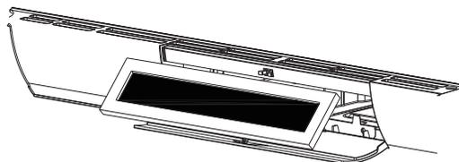
6. Presione la parte inferior del filtro de carbón para colocarlo en la posición correcta.
