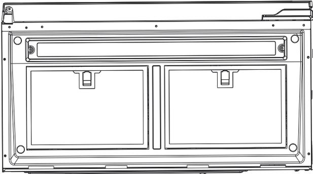
1. Para extraer el filtro de grasa, tire de la palanca y, a continuación, tire del filtro hacia abajo. El filtro caerá.
