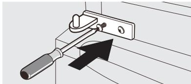
11. Installez la porte du congélateur sur l'appareil. La charnière supérieure et le cache de la charnière supérieure se trouvent dans le sac d'accessoires. Installez-la sur la partie supérieure gauche de l'appareil. Installez le cache du trou des vis sur la partie supérieure droite de l'appareil.
