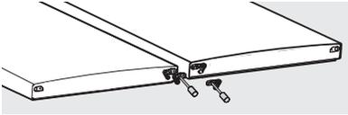
10. Instale la puerta del refrigerador en el gabinete. Dé vuelta la bisagra central e instálela en el lado izquierdo central del gabinete.
