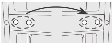
5. Retire ambas patas ajustables de la parte inferior del gabinete. Retire la bisagra inferior del lado inferior derecho del gabinete.
