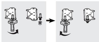
8. Instale la bisagra inferior en el lado inferior izquierdo del gabinete. Instale ambas patas de ajuste en la parte inferior del gabinete.
