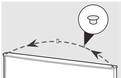
4. Mueva las cubiertas de los orificios para tornillos desde el lado izquierdo central del gabinete hasta el lado derecho central del gabinete.
