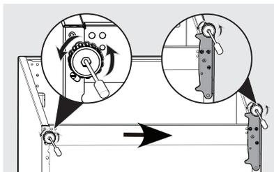
6. Mueva las cubiertas de los orificios de los tornillos desde la parte inferior izquierda del gabinete hasta la parte inferior derecha del gabinete.
