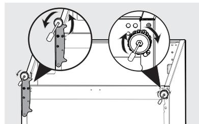
9. Desenrosque el tope central derecho con el bloque de metal de la parte inferior de la puerta superior. El tope central izquierdo y el bloque de metal se encuentran en la bolsa de accesorios. Instálelo en el lado izquierdo de la parte inferior de la puerta superior. (La misma operación que para la puerta inferior).
