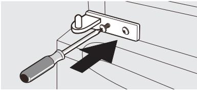
11. Instale la puerta del congelador en el gabinete. La bisagra superior y la cubierta de la bisagra superior se encuentran en la bolsa de accesorios. Instálaslas en el lado superior izquierdo del gabinete. Instale la cubierta del orificio del tornillo en el lado superior derecho del gabinete.
