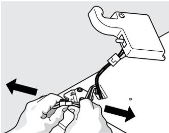
Débranchez le connecteur du câble multipolaire situé au-dessus de la charnière du haut. Poussez sur le câble et le verrou et séparez les 2 câbles.
