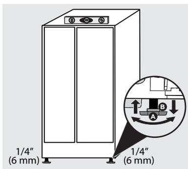
3. Assurez-vous que les deux portes ne sont pas entravées et que les joints d'étanchéité sont en contact avec la carrosserie des 4 côtés.
