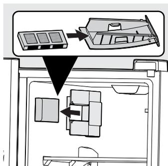
Vous devriez changer votre filtre à air tous les 6 mois (le voyant lumineux d'état du filtre sur le panneau de commande vous rappelle de remplacer le filtre au bout de 6 mois) pour réduire au maximum les odeurs dans le réfrigérateur. Les différents aliments produisent des odeurs à des degrés différents. Installation de votre nouveau filtre à air **PureAir Ultra II** :
