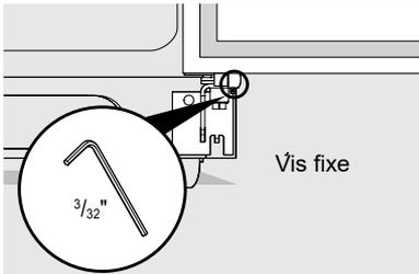
2. Si la porte du congélateur est plus basse que celle du réfrigérateur (A) ou si la porte du réfrigérateur est plus basse que la porte du congélateur (B), soulevez la porte concernée en tournant la vis de réglage dans le sens des aiguilles d'une clé de 10 mm.
