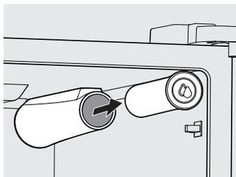
Il n'est pas nécessaire de couper l'alimentation en eau pour changer le filtre. Soyez prêt à essuyer de petites quantités d'eau durant le remplacement du filtre.
