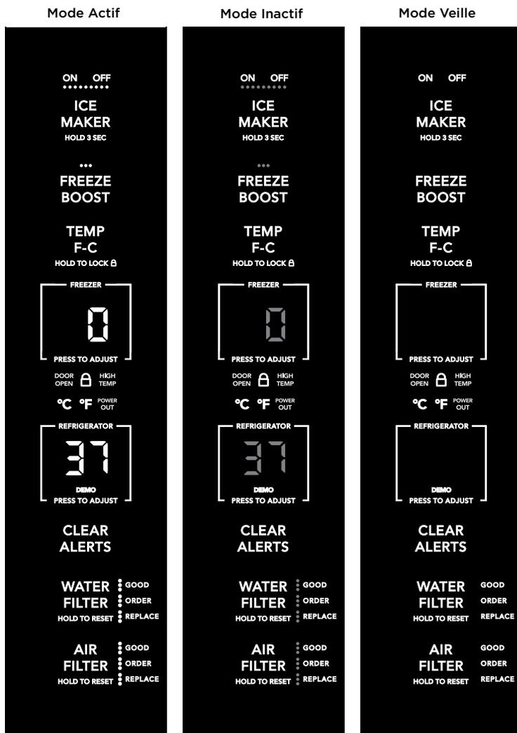
Votre écran d'affichage des commandes de l'appareil est équipé d'un mode veille et d'un mode inactif pour empêcher les modifications accidentelles des réglages de l'appareil lorsque vous ouvrez et fermez des portes. Lorsque les deux portes sont fermées, l'affichage est en mode veille. Lorsque l'une des portes est ouverte, l'affichage se met en mode inactif avec tous les réglages actuels visibles, mais avec une intensité lumineuse atténuée.
