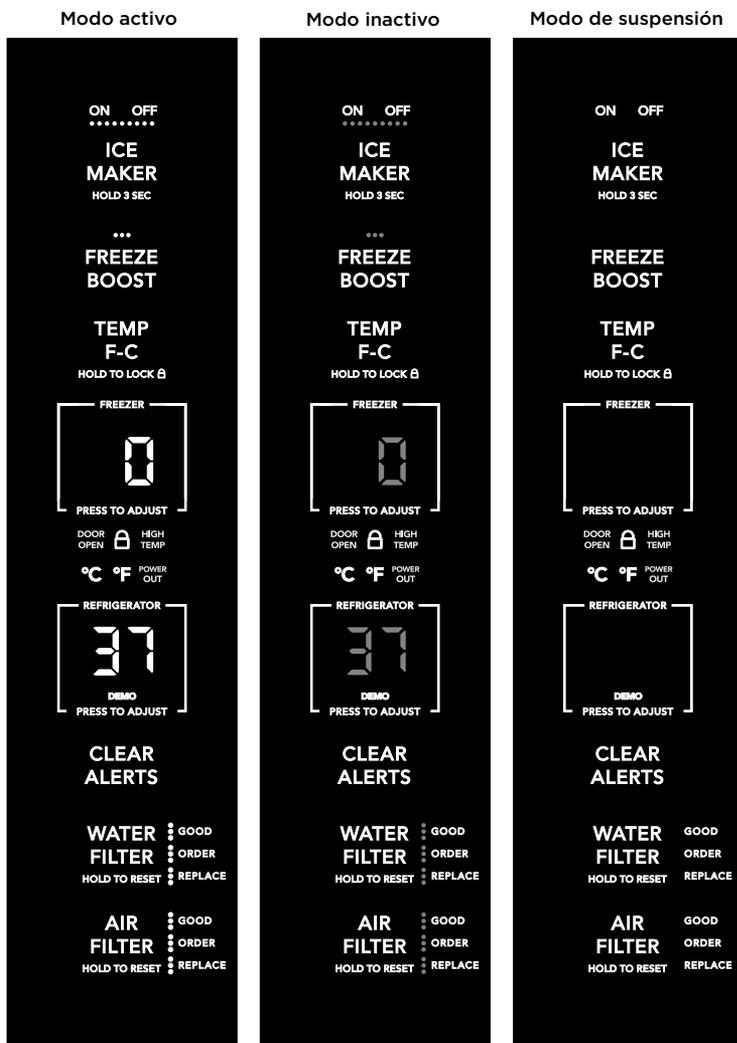
La pantalla de control del electrodoméstico está equipada con un modo de suspensión y un modo inactivo para evitar cambios accidentales en la configuración de la unidad durante la apertura y cierre de las puertas. Cuando ambas puertas estén cerradas, la pantalla estará en modo de suspensión. Al abrir por primera vez cualquiera de las puertas, la pantalla estará en modo inactivo y todos los ajustes actuales estarán visibles, pero atenuados.
