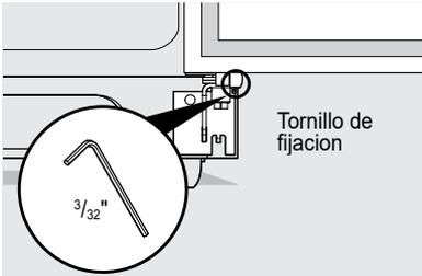
2. Si la puerta del congelador está más baja que la puerta del refrigerador (A) o la puerta del refrigerador está más baja que la del congelador (B), levante la puerta girando el tornillo de ajuste en el sentido de las agujas del reloj con una llave de 10 mm.
