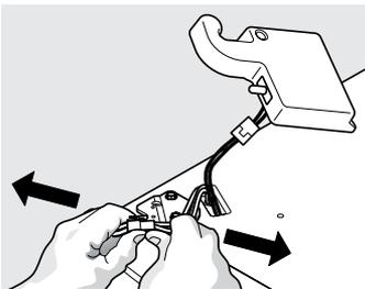
Retire el conector del cable de varios hilos ubicado arriba de la bisagra superior. Presione el cable y bloquee y separe los 2 cables.
