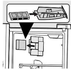
Debe cambiar el filtro de aire cada 6 meses (la luz de estado del filtro del panel de control le indica que debe reemplazar el filtro a los 6 meses) para optimizar la reducción de olores del refrigerador. Los diferentes tipos de alimentos emiten olores de intensidad diversa. Para instalar el nuevo filtro de aire **PureAir Ultra II**:
