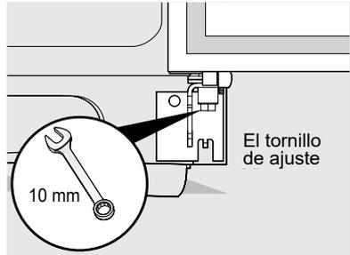
4. Vuelva a instalar el tornillo de fijación, bloqueando la altura de la puerta.
