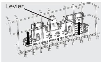
Pour réduire la partie supérieur du rack, appuyez sur le levier et poussez vers le bas sur le rack.
