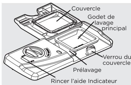
**Si le couvercle est ferme sur la cuvette de lavage principale, ouvrir en appuyant sur le verrou du couvercle.**
