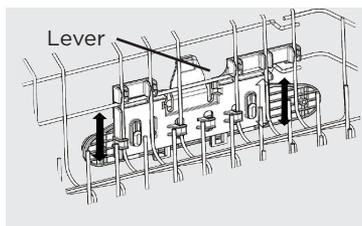
Para bajar el bastidor superior, presione la palanca y empuje hacia abajo en el rack.
