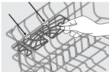
Coloque los clips del estante para tazas sobre los alambres horizontales del estante y empuje hacia abajo para fijar el estante para tazas en el segundo alambre para el estante superior.
