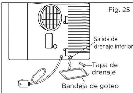
Nota: Para asegurarse de que se haya eliminado todo el residuo de condensado, incline la unidad levantándola levemente desde el frente hasta que no salga más condensado de la salida de drenaje.
