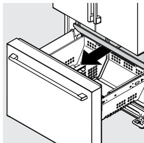
3. Empuje ligeramente hacia adentro las lengüetas de la canasta para liberar la canasta superior de los montajes de la corredera (1 por lado, en el frente).
