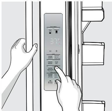
2. Para empezar a llenar el sistema, mantenga presionado un vaso contra la paleta del dispensador de agua. Podría tomar hasta 4 minutos para purgar el aire del sistema.
