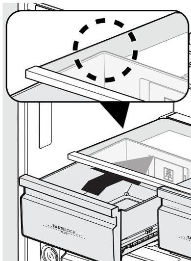
2. Empuje el cajón para frutas y verduras en línea recta una vez que los rodillos inferiores pasen sobre los rodillos de soporte del cajón de fiambres.
