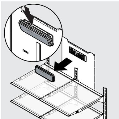
Para garantizar un filtrado óptimo de los olores del refrigerador, debe cambiar el filtro de aire cada 6 meses (la luz de estado del filtro en los controles principales le indica que reemplace el filtro después de 6 meses).
