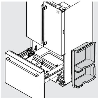
2. Extraiga las dos correderas superiores del compartimento del congelador, extendiéndolas completamente.
