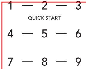
El calentamiento o la cocción por microondas se pueden configurar rápidamente a un nivel de potencia del 100 % durante 1-9 minutos. Utilice las teclas numéricas 1-9 para elegir los minutos de cocción deseados (esta opción solo funcionará utilizando los botones numéricos 1-9).
