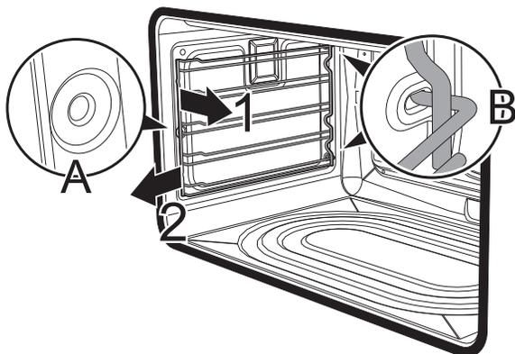
1. Lorsque le nettoyage est terminé, répétez les procédures ci-dessus pour réinstaller les cadres.
