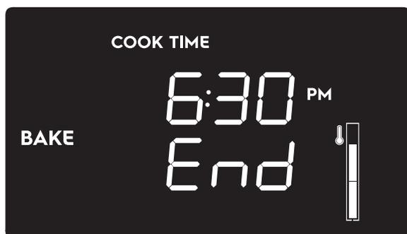
En tournant et en relâchant le bouton de mode du four vers la gauche ou après quelques secondes d'attente, l'affichage passe à l'écran de veille (heure actuelle uniquement) avec la barre de température décroissante pour indiquer que l'intérieur du four est encore chaud.
