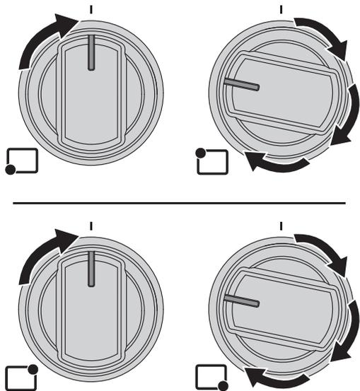
Les deux afficheurs de la zone de cuisson indiquent maintenant le niveau 0 et des points rouges clignotants apparaissent sur tous les afficheurs. La fonction Couplage est maintenant activée.
