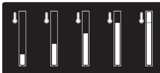
Lorsque le préchauffage est terminé, les segments de la barre de température et l'icône
