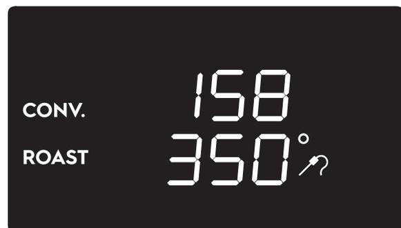
4. Tournez le bouton de température du four pour changer la température de l'intérieur du four.
