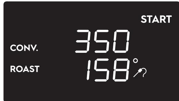
3. Appuyez sur le bouton de température du four pour changer la température de l'intérieur du four. L'afficheur montrera la température par défaut à l'intérieur du fond du four avec le symbole de degré clignotant. Le mot « + » disparaît.
