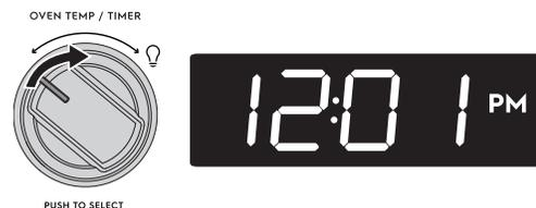
Une fois l'heure réglée, l'afficheur passe en mode veille où seule l'heure actuelle est affichée. Pour régler l'horloge de l'afficheur après la configuration initiale, en mode veille, il suffit de maintenir la rotation du bouton de température vers la gauche ou la droite pendant au moins 3 secondes, jusqu'à ce que vous voyiez les chiffres des heures clignoter.
