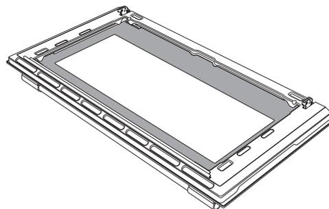
4. Remplacez les panneaux dans l'ordre inverse dans lequel ils ont été retirés. Repositionnez le panneau de verre interne. Prenez soin de centrer et d'insérer les 4 goujons attachés au verre dans leurs rainures sur la porte du four en appliquant une légère pression.
