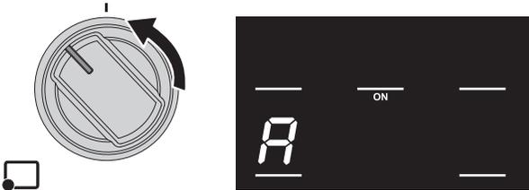
3. Maintenir le bouton enfoncé et sélectionner le niveau de puissance requis dans les 3 secondes. L'afficheur de la zone de cuisson correspondante indiquera **A** et le numéro du niveau de puissance sélectionné en alternance.
