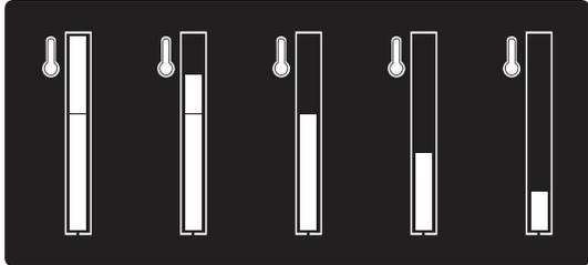
La barre de température disparaît lorsque la température de l'intérieur du four passe en dessous de 140 °F (60 °C).
