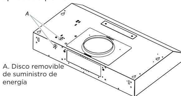
4. Con la ayuda de 2 o más personas, levante la campana y colóquela en su posición final. Haga pasar suficiente cable eléctrico a través del protector de cables de 1/2" que esté en la lista de UL o aprobado por CSA para hacer las conexiones en la caja de terminales. Apriete los tornillos del protector de cables.
