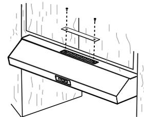
**NOTA:** Para instalaciones que descargan el aire hacia el techo o la pared, la tapa recirculante debe permanecer en su lugar o este no funcionará correctamente. Para completar la instalación, vaya a la sección "Haga las conexiones eléctricas" en la página 50.
