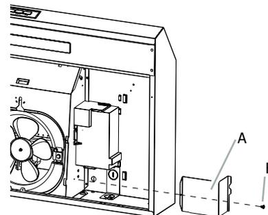
3. Quite el disco removible de suministro eléctrico de la parte superior o posterior de la capota de ventilación (dependiendo de la ubicación de la entrada del cable de suministro eléctrico de su casa) e instale un protector de cables de 1/2" que esté en la lista de UL o aprobado por CSA.
