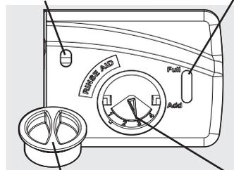
Bouchon du distributeur      Cadran de réglage
