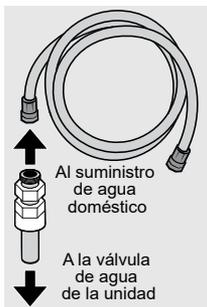
3. Abra los ganchos de bloqueo y agarre la tubería de agua que viene del refrigerador. Retire el tapón de plástico del racor de la toma de agua y deséchelo.
