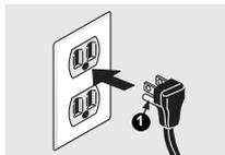
1. Cable de alimentación con clavija de conexión a tierra.
