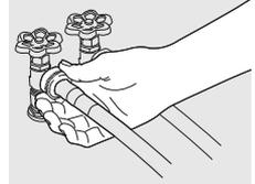
6. Ajuste a mano hasta que quede apretado. Luego apriete cada conexión de suministro 2/3 de vuelta más con pinzas. **No doble, retuerza ni pellizque las mangueras de entrada de agua.**
