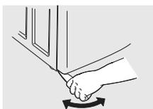
3. Presione hacia abajo las esquinas y los lados alternos y sienta el menor movimiento. Ajuste las patas apropiadas de manera que quede firmemente apoyada en el piso en las CUATRO patas. Mantenga la extensión de la pata de nivelación al mínimo para un mejor rendimiento del centro de lavandería.
