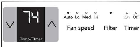
Cette fonction est un rappel de nettoyage du filtre à air (Voir la section Entretien et Nettoyage) pour maximiser le fonctionnement. Le voyant s'allumera après 250 heures de fonctionnement. Pour réinitialiser la fonction après le nettoyage du filtre, appuyez sur le bouton de "Réinitialisation du Filtre", et le voyant s'éteint.
