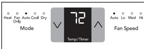
Ce mode est une combinaison fixe du mode Refroidissement et du réglage automatique de la vitesse du ventilateur. Dans ce mode, la vitesse du ventilateur ne peut pas être sélectionnée manuellement.
