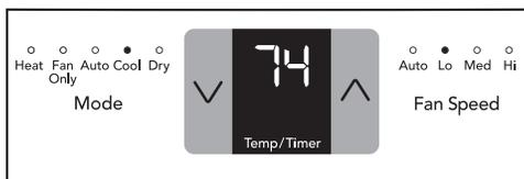
Remarque : La vitesse du ventilateur peut être sélectionnée parmi quatre paramètres : Auto, Lo(Faible), Med(Moyenne) et Hi(Élevée), sauf si l'appareil fonctionne en mode « Auto » ou « Chauffage » ou si la fonction Veille est activée.
