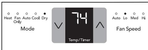
Dans ce mode, le climatiseur fonctionnera comme un déshumidificateur, mais il refroidira la pièce pendant ce temps. La température peut être réglée 62 °F (17°C) et 86 °F (30 °C) et la vitesse du ventilateur est maintenue à « ventilateur Lo ».
