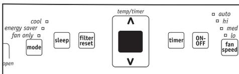
Remarque : Si l'appareil est éteint en mode Chauffage (le cas échéant) ou en mode Ventilateur uniquement, il reviendra à la même valeur lorsqu'il se remettra en marche. Lorsque l'appareil est éteint en mode Économie d'énergie ou Refroidissement il fonctionnera en mode Économie d'énergie lors de sa remise en marche, mais le réglage de la température et de la vitesse du ventilateur sera le même.
