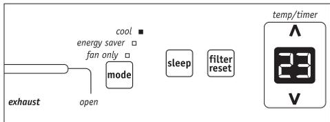
Remarque : Le contrôle peut afficher la température en degrés Fahrenheit ou en degrés Celsius.
