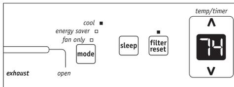
Remarque : Cette fonction est un rappel de nettoyage du filtre à air (Voir la section Entretien et Nettoyage) pour maximiser le fonctionnement. Le voyant s'allumera après 250 heures de fonctionnement. Pour réinitialiser la fonction après le nettoyage du filtre, appuyez sur le bouton de "Réinitialisation du Filtre", et le voyant s'éteint.
