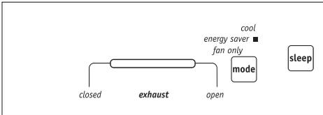
Ce contrôle d'évacuation permet au climatiseur de faire recirculer l'air intérieur (FERMÉ) ou d'évacuer l'air vers l'extérieur (OUVERT).
