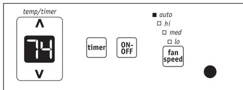
**Remarque :** Appuyez sur les touches vers le haut ( $\wedge$ ) ou vers le bas ( $\vee$ ) ou maintenez-les enfoncées jusqu'à ce que la température souhaitée apparaisse à l'écran. Cette température sera automatiquement maintenue entre 16°C (60°F) et 32°C (90°F). Si vous souhaitez que l'écran affiche la température réelle de la pièce, suivez "Pour utiliser uniquement le ventilateur".
