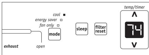
Remarque : La vitesse du ventilateur peut être sélectionnée parmi quatre paramètres : Auto, Lo (Faible), Med (Moyenne) et Hi (Élevée), sauf si l'appareil fonctionne en mode « Auto » ou « Chauffage » ou si la fonction Veille est activée.
