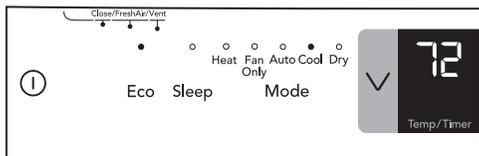
**REMARQUE :** L'appareil fonctionne en mode économie d'énergie (econ) à chaque démarrage, s'il a été arrêté en mode Froid ou économie d'énergie (econ). Pendant ce mode, le ventilateur continuera de fonctionner pendant 3 minute après l'arrêt du compresseur. Ensuite, le ventilateur se met en marche pendant 90 secondes toutes les 10 minutes jusqu'à ce que la température ambiante soit supérieure à la température de consigne, moment où le compresseur se remettra en marche.
