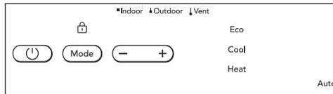
Lorsque l'appareil est éteint, l'affichage s'estompe progressivement après 3 secondes. Cet appareil revient toujours au mode éco et au réglage de la vitesse du ventilateur automatique lorsqu'il est remis en circuit.
