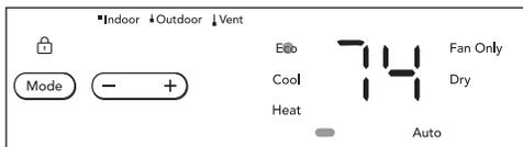
L'appareil est réglé pour fonctionner en mode Eco (économie d'énergie). Nous recommandons de laisser l'appareil en mode Eco pour économiser de l'énergie et de l'argent. Cependant, si vous souhaitez sortir du mode Eco, touchez le bouton jusqu'à la sélection d'un autre mode.
