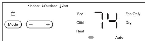
Dans ce modèle, le ventilateur reste allumé tout le temps tandis que le compresseur est en marche et en arrêt lorsque la température ambiante est atteinte.
