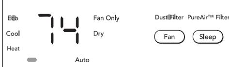
Cette fonction est un rappel de nettoyer le Filtre à poussière (voir Entretien et nettoyage) pour un fonctionnement plus efficace. La DEL (lumière) s'allume après 250 heures de fonctionnement. Pour réinitialiser l'appareil après avoir nettoyé le filtre, maintenez le bouton « Fan » (Ventilateur) pendant 5 secondes.
