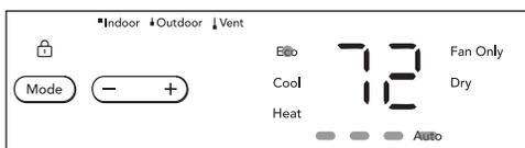
**REMARQUE :** L'appareil fonctionnera en mode Eco (économie d'énergie) à chaque mise sous tension. Pendant ce mode, le ventilateur continuera de fonctionner pendant 3 minute après l'arrêt du compresseur. Ensuite, le ventilateur se met en marche pendant 120 secondes toutes les 10 minutes jusqu'à ce que la température ambiante soit supérieure à la température de consigne, moment où le compresseur se remettra en marche.
