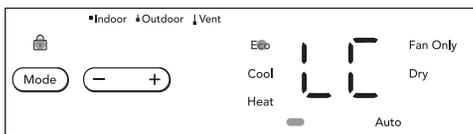
Maintenez les boutons « Vitesse du ventilateur » et « Réinitialisation du filtre » enfoncés pendant 3 secondes pour activer ou désactiver la fonction VERROUILLAGE. L'écran indiquera VR pendant 5 secondes. Le panneau de commande est verrouillé et le réglage ne peut pas être modifié.
