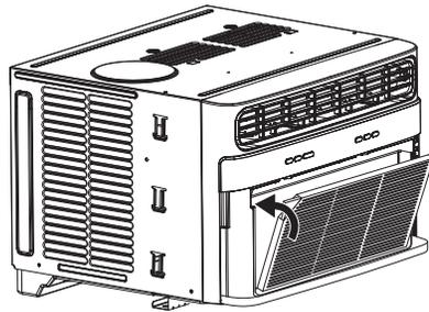
3. Réinstallez le Filtre à poussière et la grille d'admission d'air.
