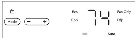
Remarque : Dans ce mode, le climatiseur fonctionnera comme un déshumidificateur, mais il refroidira la pièce pendant ce temps. La température peut être réglée 60°F (16°C) et 90 °F (32 °C) et la vitesse du ventilateur est maintenue à « ventilateur low ».
