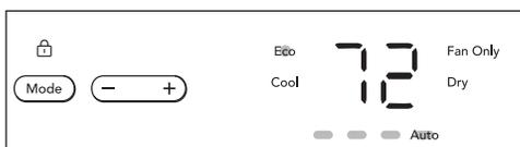
**REMARQUE :** L'appareil fonctionne en mode économie d'énergie (Eco) à chaque démarrage, s'il a été arrêté en mode Froid ou économie d'énergie (Eco). Pendant ce mode, le ventilateur continuera de fonctionner pendant 3 minute après l'arrêt du compresseur. Ensuite, le ventilateur se met en marche pendant 120 secondes toutes les 10 minutes jusqu'à ce que la température ambiante soit supérieure à la température de consigne, moment où le compresseur se remettra en marche.
