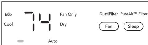
Remarque : Cette fonction est un rappel de nettoyer le Filtre à poussière (voir Entretien et nettoyage) pour un fonctionnement plus efficace. La DEL (lumière) s'allume après 250 heures de fonctionnement. Pour réinitialiser l'appareil après le nettoyage du filtre, maintenez le bouton « Fan » pendant 3 secondes et le voyant s'éteindra.
