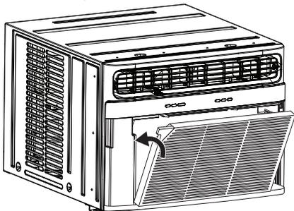
3. Réinstallez le Filtre à poussière et la grille d'admission d'air.
