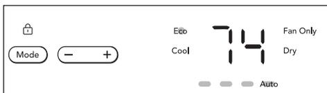
Remarque : L'affichage indique la température réglée pendant le fonctionnement normal, presser le bouton (+) ou (-) pour régler la température à celle désirée.
