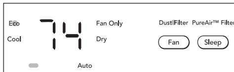
Nota: Esta función es un recordatorio para limpiar el filtro de polvo (Vea cuidado y limpieza) para una operación más eficiente. El indicador LED (luz) se iluminará después de 250 horas de funcionamiento. Para restablecerlo una vez que ha limpiado el filtro, presione el botón de «Ventilador» durante 3 segundos y la luz se apagará.
