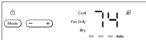
Dans ce mode, le climatiseur fonctionnera comme un déshumidificateur, mais il refroidira la pièce pendant ce temps. La température peut être réglée 60 °F (16°C) et 90 °F (32 °C) et la vitesse du ventilateur est maintenue à « ventilateur automatique ». Chaque fois que le mode Sec est sélectionné, la fonctionnalité Éco est activée par défaut. Appuyer sur la touche Éco pour la désactiver.
