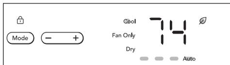
L'affichage indique la température réglée pendant le fonctionnement normal, presser le bouton (+) ou (-) pour régler la température à celle désirée. L'appareil émet deux bips si le bouton d'augmentation (+) ou de diminution (-) de la température est enfoncé de façon continue lorsque la température réglée atteint les limites supérieure et inférieure de 90 °F ou 60 °F.
