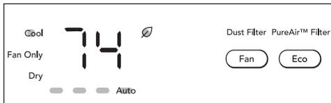
Au départ, le ventilateur démarre en vitesse élevée et s'adapte à une vitesse plus lente imposée par la température ambiante. Par exemple, si la température ambiante augmente rapidement, comme lorsqu'une porte est ouverte, le ventilateur passe automatiquement à la vitesse la plus élevée. La vitesse du ventilateur se réajustera à une vitesse plus lente lorsque la pièce se refroidira. Appuyez sur le bouton du ventilateur pour régler la vitesse du ventilateur manuellement.
