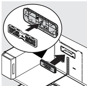
1. Placez les doigts sur le bas du couvercle du filtre à air et tirez du haut vers l'avant de l'appareil, libérant les boutons-pression supérieurs du couvercle du filtre à air de la tour d'air.
