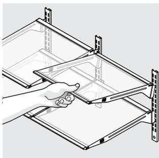
3. Remplacez en insérant les crochets du support de montage dans les fentes de support souhaitées.
