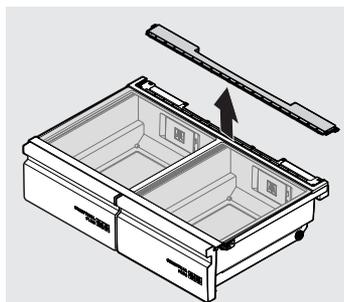
Retrait de la membrane de contrôle automatique de l'humidité
