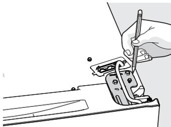
4. Retirez le couvercle de cloison à l'arrière de l'appareil pour accéder au tube d'eau. Débranchez le tube d'eau au niveau du raccord push-lock à l'arrière de l'appareil, sous la cloison. La conduite du distributeur est reliée à la conduite d'eau jaune provenant de la vanne d'eau principale.
