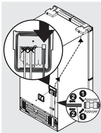
5. Retirez le tube d'eau du conduit par le haut de l'armoire.
