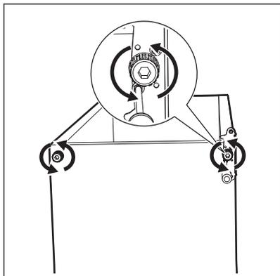
5. Desatornille y retire el pasador de bisagra inferior, dé la vuelta al soporte y vuelva a colocarlo.
