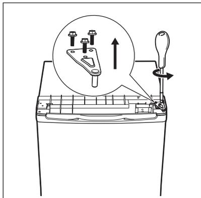
4. Desatornille la bisagra inferior. Retire las patas ajustables de ambos lados.
