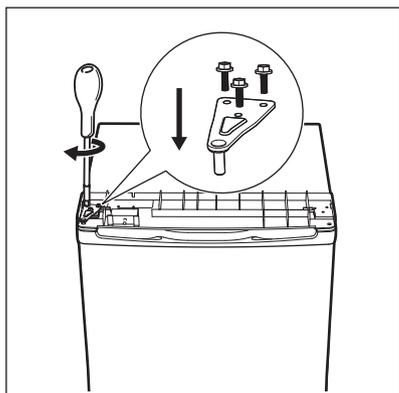
8. Coloque la tapa superior en la parte trasera y fijela con 2 tornillos.
