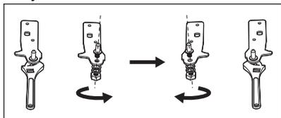
6. Vuelva a ajustar el soporte con el pasador de bisagra inferior. Vuelva a colocar ambas patas ajustables.
