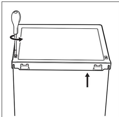
2. Retire la tapa superior y la perilla del termostato. Apártelas.
