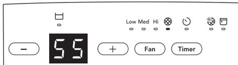
9. Si se instala el filtro PureAir™ (se vende por separado), el indicador "Filtro PureAir™" se iluminará una vez finalizada la vida útil del filtro PureAir™. Presione y mantenga presionado el botón "Temporizador" durante 3 segundos para restablecer después de reemplazar el filtro avanzado.
