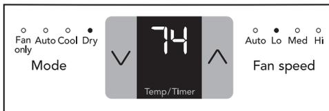
Remarque : Dans ce mode, le climatiseur fonctionnera comme un déshumidificateur, mais il refroidira la pièce pendant ce temps. La température peut être réglée 62 °F (17 °C) et 86 °F (30 °C) et la vitesse du ventilateur est maintenue à « Faible ».
