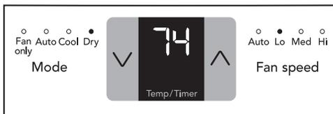
Nota: En este modo, el aire acondicionado funcionará como un deshumidificador, pero enfriará la habitación mientras tanto. Se puede ajustar la temperatura entre 62 °F (17 °C) y 86 °F (30 °C) y se mantendrá la velocidad del ventilador en "Lo".
