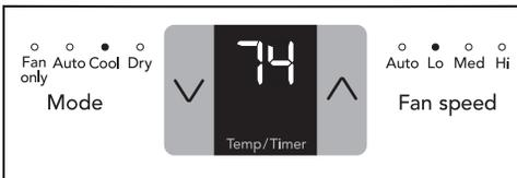
Nota: Se puede seleccionar la velocidad del ventilador entre cuatro configuraciones: Auto (Automático), Lo (Bajo), Med (Medio) y Hi (Alto), a no ser que se ejecute en modo "Automático" o "Seco", o esté activada la función de reposo.
