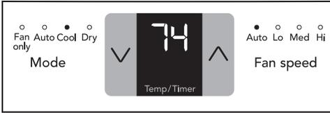
Nota: Pulse una vez o mantenga presionado tanto el botón arriba ( ^ ) como el botón abajo ( V ) hasta que se muestre la temperatura deseada en la pantalla. Esta temperatura se mantendrá automáticamente entre 62 °F (17 °C) y 86 °F (30 °C). Si quiere que la pantalla muestre la temperatura actual de la estancia, consulte la sección "Para operar sólo en modo ventilador".
