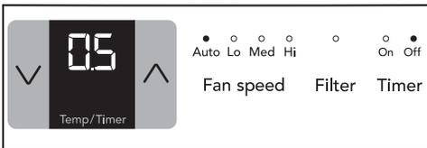
La configuración de la combinación de retraso de parada apagado retraso de encendido o retraso de encendido encendido, retraso de parada es practicable. Los dos indicadores de "temporizador apagado" y "temporizador encendido" se iluminarán entonces. Se puede cancelar la configuración del temporizador al mantener pulsado el botón del temporizador durante 2 segundos, o al pulsar el botón de encendido/apagado en cualquier momento para apagar la unidad directamente.
