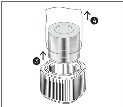
Réinsérez délicatement le filtre dans le produit (les deux extrémités du filtre peuvent être utilisées). Veillez à ce que le filtre soit placé au centre de la cavité.
