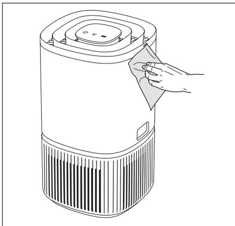
La zone autour de l'entrée d'air en bas de l'appareil peut accumuler plus de poussière que d'autres pièces et peut donc nécessiter un nettoyage plus fréquent pour garantir des performances optimales. Le filtre est muni d'un filtre à mailles et doit être essuyé de temps en temps ou nettoyé à l'aide d'un aspirateur pour éviter une perte de performance.
