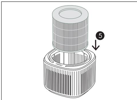
Remplacez la partie supérieure du corps principal pour fermer le produit jusqu'à ce qu'il soit bien en place. La marque « AVANT » doit être orientée vers la face avant du produit.
