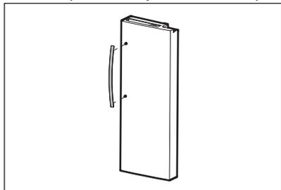
2. Gire el tornillo de fijación Allen en la parte superior de la manija hacia la derecha con la llave Allen. Apriete para fijar la manija. Repita la
