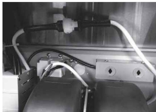
6. Branchez le connecteur Molex à six broches du boîtier du tableau de commande au connecteur Molex à six broches du câble du boîtier du condensateur. Fixez le câble à l'intérieur de la hotte avec une attache mono-usage et un porte-attache mono-usage.
