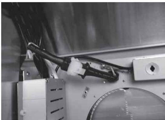
5. Branchez le connecteur mâle à six broches du ventilateur à distance au connecteur femelle à six broches du tableau de commande.
