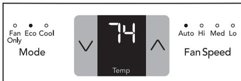
Nota: La pantalla mostrará la temperatura establecida durante el funcionamiento normal, presione el botón arriba (^) o abajo (v) para ajustar la temperatura establecida a la configuración deseada. La unidad pitará dos veces si se mantiene presionado el botón de temperatura arriba (^) o abajo (v) cuando la temperatura establecida alcance los límites máximos/mínimos 90°F o 60°F.
