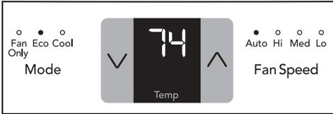
La unidad esta configurada de fábrica para funcionar en modo eco (ahorro de energía). Recomendamos mantener la unidad en modo eco para ayudar en el ahorro de energía y dinero. Pero si desea cambiar el modo eco, toque el botón hasta que se seleccione otro modo.
