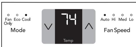
Nota: En este modelo, el ventilador permanece encendido todo el tiempo y el compresor se enciende y se apaga, según si se alcanza o no la temperatura de la habitación.
