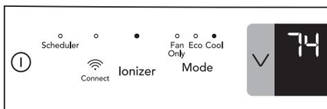
Nota: La unidad está equipada con un dispositivo de limpieza de aire interno que se llama ionizador. Al activar esta función, el ionizador genera iones en el aire y atrae y remueve las impurezas del aire. Esto proporciona un aire más limpio y sano que respirar.
