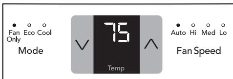
Nota: Use esta función en algunos modelos solamente cuando no desee enfriar, como por ejemplo para permitir la circulación del aire o para eliminar el aire viciado. Puede seleccionar la velocidad de ventilador que prefiera. (Excepto "Ventilador Automático"). Durante esta función, la pantalla solo mostrará la temperatura ambiente real y la temperatura establecida no se puede cambiar.
