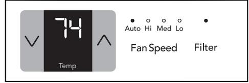
Nota: Esta característica es un recordatorio para limpiar el filtro de aire (Consulte Cuidado y limpieza) para un funcionamiento eficiente. La (luz) LED se encenderá después de 250 horas de funcionamiento. Para reiniciar después de limpiar el filtro, presione el botón "reiniciar filtro" durante 3 segundos y la luz se apagará.
