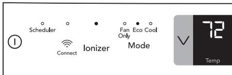
**NOTE: La unidad funcionará en modo de ahorro de energía (econ) cada vez que se encienda, si cuando se apague está en modo de enfriamiento o de ahorro de energía (econ).** En este modo, el ventilador continuará funcionando durante 3 minuto después de que el compresor se cierre. Luego el ventilador realizará ciclos de 90 segundos con intervalos de 10 minutos cada uno hasta que la temperatura de la habitación supere la temperatura establecida, en ese momento, el compresor volverá a encenderse.
