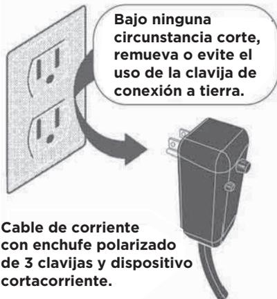
Cable de corriente con enchufe polarizado de 3 clavijas y dispositivo cortacorriente.
