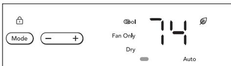
Cada vez que se selecciona el modo Cool (Frío), la función ECO se activará de manera predeterminada. Pulse el botón ECO para desactivarla. Cuando la función ECO está desactivada, el ventilador permanece encendido durante todo el tiempo mientras el compresor se enciende y se apaga una vez que se ha alcanzado la temperatura ambiente deseada.
