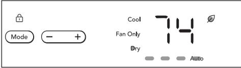
En este modo, el aire acondicionado funcionará como un deshumificador, pero enfriará la habitación mientras tanto. Se puede ajustar la temperatura entre 60 °F (16° C) y 90 °F (32 °C) y se mantendrá la velocidad del ventilador en "Auto". Cada vez que se selecciona el modo Dry (Seco), se activará la función ECO de manera predeterminada. Pulse el botón ECO para desactivarla.
