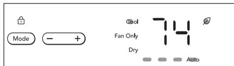
La pantalla mostrará la temperatura establecida durante el funcionamiento normal, presione el botón arriba (+) o abajo (-) para ajustar la temperatura establecida a la configuración deseada. La unidad emitirá dos pitos si el botón de la temperatura hacia arriba (+) o hacia abajo (-) si pulsa de manera continua cuando la temperatura configurada alcanza los límites superiores o inferiores de 32 °C o 15 °C (90 °F o 60 °F).
