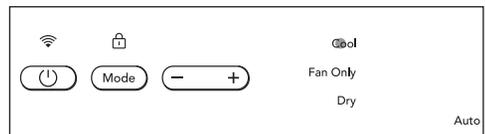
Cuando se apaga la unidad, la pantalla se irá apagando poco a poco en 3 segundos. La unidad siempre regresará el modo "eco" y la velocidad de ventilador "auto" cuando vuelva a encenderse.
