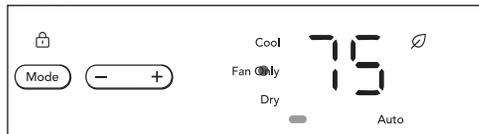
Use esta función cuando no quiera enfriar, como para que circule el aire en la habitación o para que salga el aire viejo residual. Puede seleccionar la velocidad de ventilador que prefiera. (Excepto "Ventilador Automático"). Durante esta función, la pantalla solo mostrará la temperatura ambiente real y la temperatura establecida no se puede cambiar.
