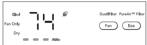
Esta función es un recordatorio para limpiar el filtro de polvo (Vea cuidado y limpieza) para una operación más eficiente. El indicador LED (luz) se iluminará después de 250 horas de funcionamiento. Para restablecer el aparato después de limpiar el filtro, sujete el botón de «Ventilador» pulsado durante 5 segundos.
