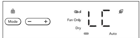
Pulsar y mantener pulsados los botones de "Velocidad del ventilador" y "Restablecimiento del filtro" durante 3 segundos puede activar o desactivar la función de BLOQUEO. Esto mostrará LC durante 5 segundos. El panel de control se bloqueará y la configuración no se puede cambiar.
