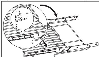
4. Déployer et reposer la grille de four coulissante plusieurs fois le long des rails pour répartir la lubrification.
