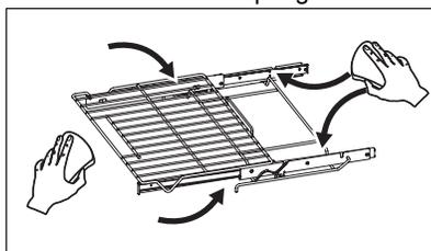
3. Bien agiter le lubrifiant au graphite avant de l'appliquer. Appliquez aux guides de chargement et à l'axe de rotation. Répétez l'opération des deux côtés de la grille de four coulissante.
