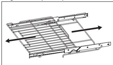
5. Retournez la grille de four et appliquez du lubrifiant au graphite sur l'intérieur des guides de chargement.
