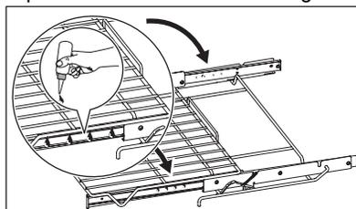
4. Déployer et replier la grille de four coulissante plusieurs fois le long des rails pour répartir la lubrification.
