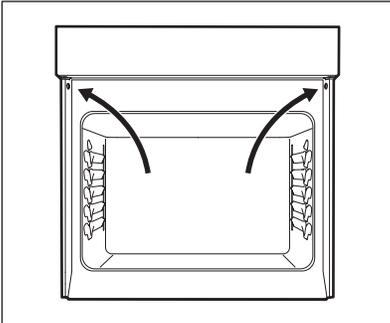
Trous de fixation antibasculement.
