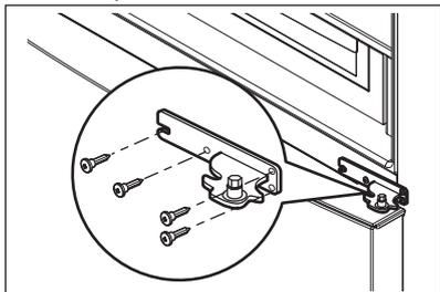
5. Pour réinstaller les portes, inversez la procédure.
