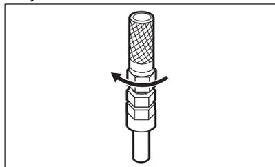
4. Si (tel que recommandé) un tuyau tressé en acier inoxydable est utilisé, l'écrou et la bague sont déjà montés sur le tuyau. Faites glisser l'écrou à compression sur le raccord
