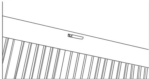
3. Alignez les deux (2) rondelles en plastique au bas de la grille avec les trous du bord arrière du boîtier. Fixez avec les deux (2) vis fournies à partir de l'intérieur.
