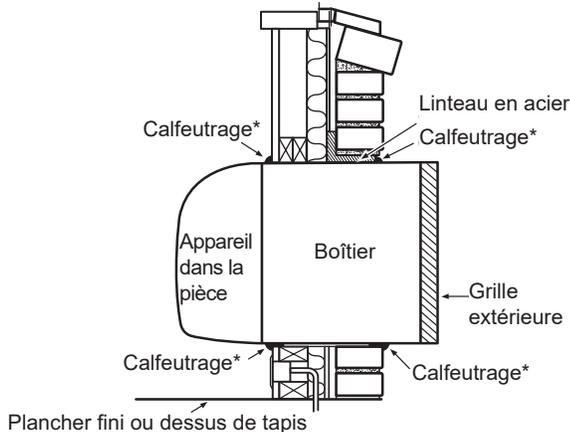
**REMARQUE: \*Il est essentiel de calfeutrer le périmètre de la gaine murale sur les quatre côtés à l'extérieur et l'intérieur, là où il joint le bâtiment, afin de prévenir les infiltrations d'air et d'eau.**
