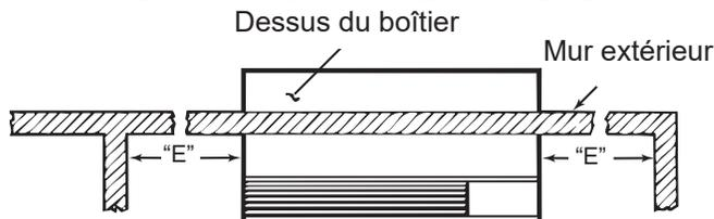
**REMARQUE:** si vous utilisez un drain interne, installez le manchon mural à niveau d'un côté à l'autre et à niveau de l'avant vers l'arrière.
