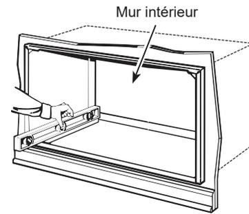
2. Fixez solidement la gaine à la structure murale en utilisant les trous existants sur les côtés et le dessus, ou en perçant de nouveaux trous aux endroits appropriés. Ne percez AUCUN trou dans le bas de la gaine. Utilisez les vis, les tirefonds, etc. appropriés pour fixer la gaine sur la structure du mur.
