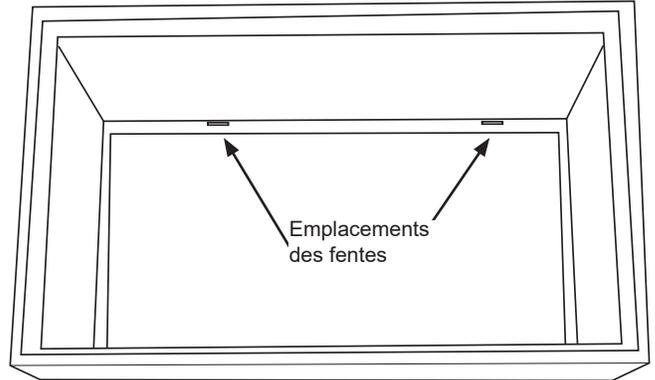
Insérez les languettes du dessus de la grille dans les deux fentes supérieures du bord arrière. Assurez-vous que les deux (2) languettes sont passées dans les fentes et visibles à l'intérieur du boîtier.
