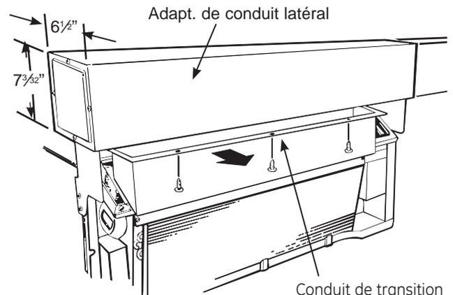
4. Le conduit de transition utilisé, les trois vis (si utilisées) et tout joint d'étanchéité utilisé pour sceller l'ancien conduit de transition sur le châssis ne sont pas nécessaires pour la nouvelle installation, mais il faut les garder pour une réutilisation possible avec l'ancien châssis à cet emplacement.
