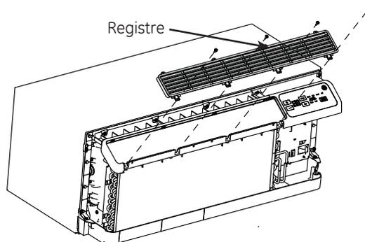
4. Alignez la bande d'étanchéité métallique comme illustré et fixez-la avec les quatre vis de montage du registre.
