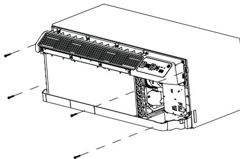
3. Retirez et conservez les quatre vis fixant le registre au châssis. Soulevez et retirez le registre.
