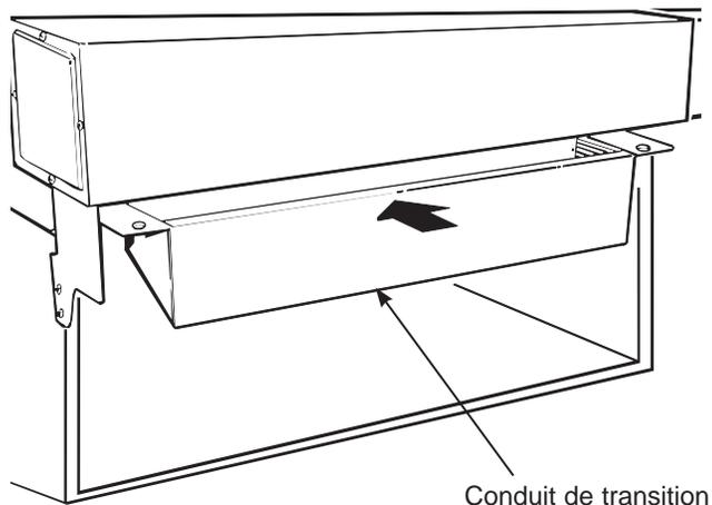
2. Utilisez le pointeau pour marquer les emplacements de trou de vis de montage du conduit de transition dans l'adaptateur de conduit latéral. Utilisez les trous dans les brides à chacune des extrémités du conduit de transition comme gabarit. Assurez-vous que le conduit de transition est de nouveau entièrement en place lorsqu'on réalise les impressions de pointeau.
