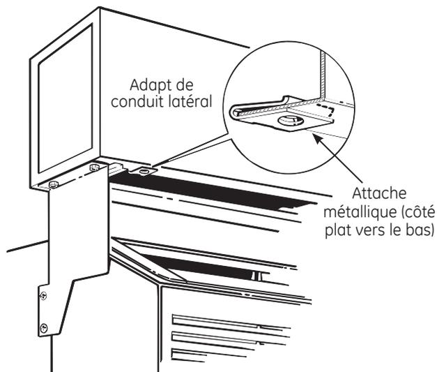
3. Enlevez le conduit de transition et percez deux trous de 1/4 po aux emplacements faits avec le pointeau. Faites glisser les attaches métalliques sur les flasques à ces emplacements, comme indiqué dans l'illustration.
