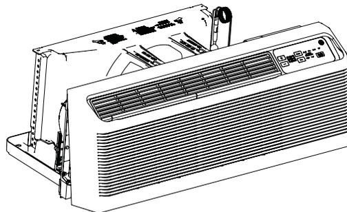
2. Faites glisser le châssis dans le boîtier et fixez-le en place avec les quatre vis fournies avec l'unité Zoneline dans les trous de bride du châssis.
