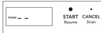
Una vez que el voltaje vuelve a la normalidad, el lavavajillas reanuda automáticamente el ciclo de lavado si no se ha abierto la puerta. Si la puerta se abre durante la condición de suministro de energía anormal, presione Start (Iniciar) y cierre la puerta dentro de los 4 segundos para que el ciclo se reanude cuando el suministro de energía vuelva a la normalidad.
