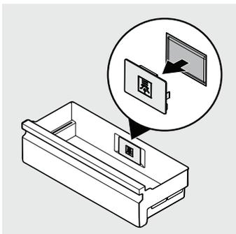
1. Extienda por completo el cajón para frutas y verduras, para facilitar el acceso. Sujete la cubierta con la mano, tirando hasta que se libere del cajón para frutas y verduras.
