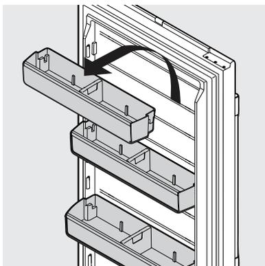
**Para instalarlo**, deslice el divisor hacia abajo en los correspondientes puntos de alineación del contenedor de puerta hasta que quede en su lugar.
