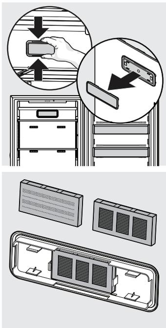
La carcasa del filtro de aire está ubicada en la parte superior trasera central del gabinete, detrás de una placa decorativa removible de acero inoxidable. Para instalar el elemento del filtro de aire:
