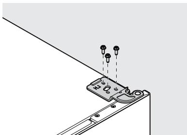
Si el transporte de la unidad requiere la remoción de la puerta, debe tener un espacio de puerta de 9 mm uniforme alrededor del perímetro del compartimento para garantizar el sellado correcto de la junta y evitar la escarcha en el congelador. Mida la separación de 9 mm entre el metal del compartimento y el metal de la puerta.
