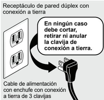
Use una toma de corriente dúplex con conexión a tierra para cada unidad (es decir, dos receptáculos de toma de corriente dúplex, cada uno en un circuito eléctrico dedicado) para una configuración de unidades acopladas.
