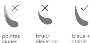
Allumez pour vérifier l'ajustement. Si la flamme est bleue et stable, serrez la vis de l'obturateur d'air et réinstallez toutes les pièces. Si la flamme est toujours instable, répétez les étapes ci-dessus.
