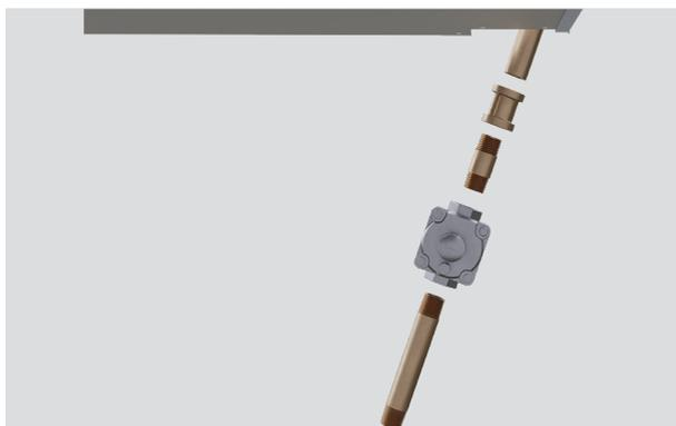
2. Asegúrese de que la flecha del regulador apunte hacia el flujo de gas, en la dirección contraria al suministro de gas. Utilice compuesto para roscado únicamente en las roscas macho.
