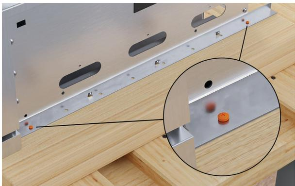
5. Retire los dos tornillos Phillips que sujetan los soportes para transporte a la plataforma de carga.
