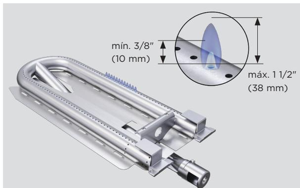
3. Las llamas deben ser azules y estables. Una llama amarilla indica que no hay suficiente aire. Una llama ruidosa que se eleva por sobre el quemador indica que hay demasiado aire.
