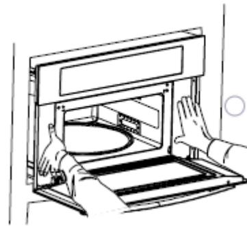
3. À l'aide d'un foret de 1/8 po (3,2 mm), percer des avant-trous dans les glissières de montage situées de chaque côté du four à micro-ondes.
